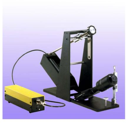
光源にレーザーを採用し、バイ アスコープ型にすることにより、 ナトリウムランプでは測定出来 ない、ホーロー、七宝、陶磁器 釉薬、フロート法によらない板ガ ラスなどの応力測定も可能
