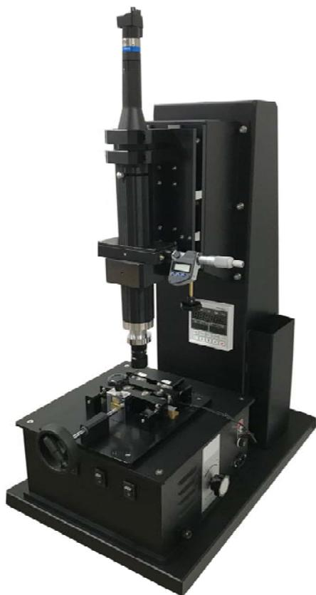
本機は、ガラスの光弾性定数を測定します。偏光や複屈折を利用したガラスの応力測定において、光弾性定数は必須の物理定数です。
