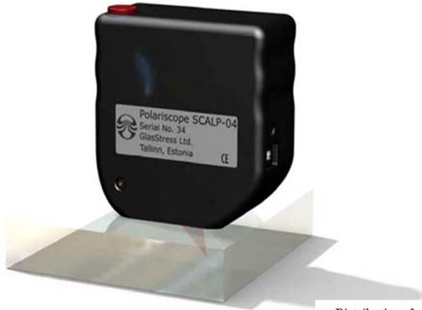
ガラス断面応力計SCALP-シリーズは散乱光光弾性理論に基づき断面応力を測定するために開発された装置です。ガラスの内部に沿って光を通過させ、光弾性技術により断面の応力やその分布を測定するものです。本機はコンピュータに管理され測定者による誤差を軽減し測定データの管理等にも優れた機能を発揮するものです。(表面付近200umは検出できないため化学強化ガラスには適用されません)
