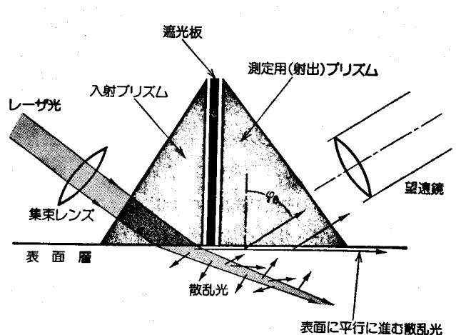
第3図 表面応力計の基本構造
