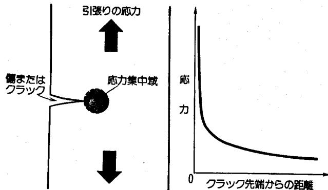
第1図 傷の先端での引張り応力の集中
