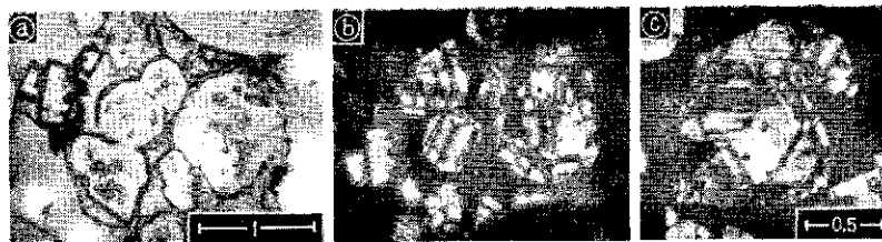
図 19. リュサイト粒 (b), (c) 直交ニコル——層状そう晶を示す Grains of leucite (b), (c) crossed nicols—Showing laminar twinning
