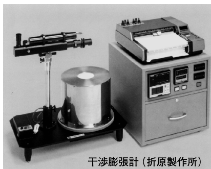
図2 電気炉/干渉計/2-ペン記録計/温度調節系からなる
